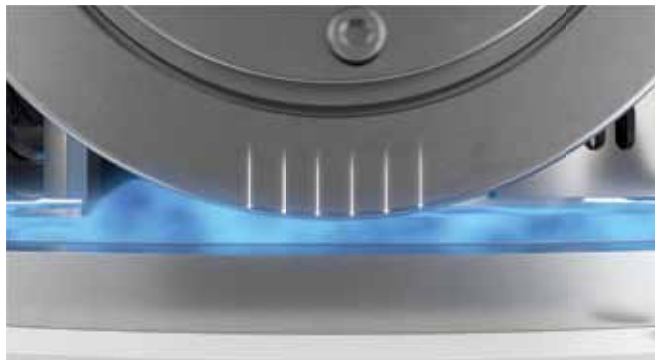
„Distamat“ omogućava konstantan razmak valjka tokom rada.
