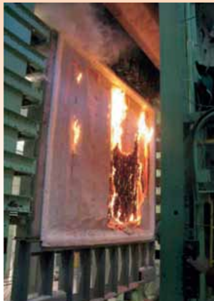
Slika 4. Testiranje požarne otpornosti drvenih panela
