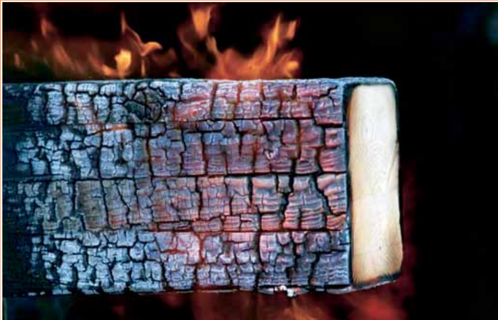
Slika 2. Ugljenisani sloj formiran sa sve četiri bočne strane drveta i nepromenjena unutrašnjost drveta
