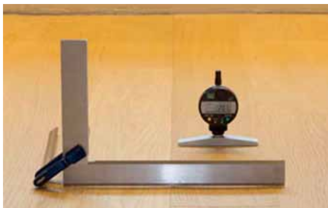
Slika 2: Merenje deformacija na višeslojnom parketu (Izvor: Korak u prostor, 2018.)
