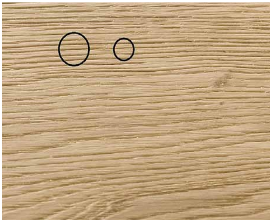
Slika 1: Veličina otiska kuglice na površini drveta po RVO metodi (levo) i po Brinell-ovoj metodi (desno)
