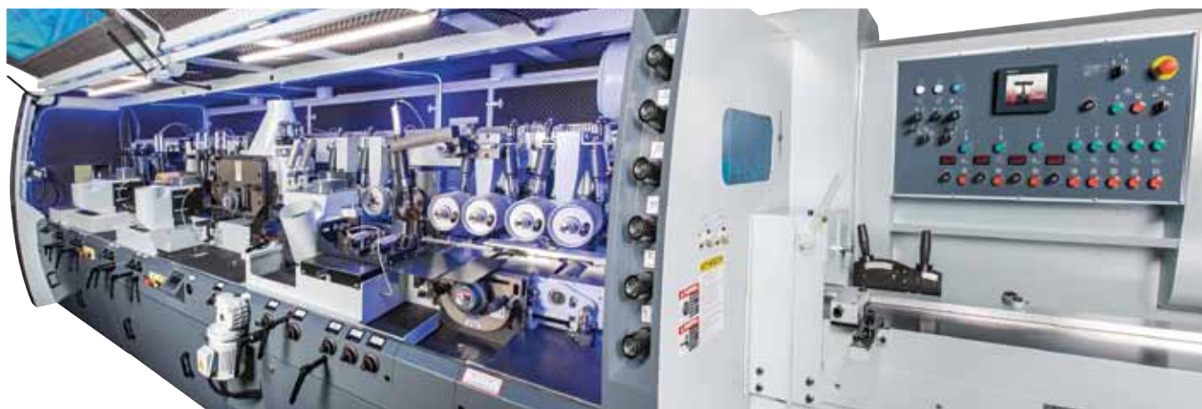
Hypermac mašina koja može da ima 4 do 9 osovina sa brzinom do 36 m/min.
