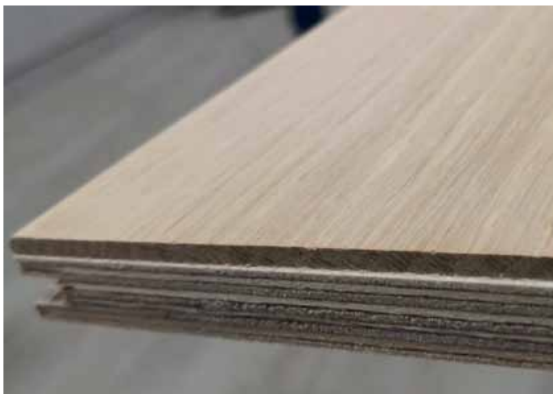
Slika 1. Poprečni presek dvoslojnog poda (konstruktivni sloj od šperploče) i princip slaganja kod troslojnog poda
