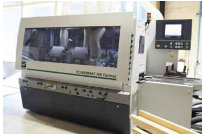
Za čistu površinu stara se Weinig Powermat 700 sa prozorskim paketom
