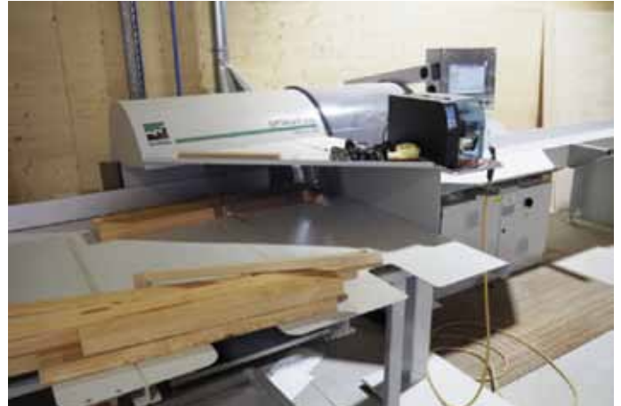
...posle toga Opticut S50 od Weinig Dimter-a krati drvo na odgovarajuće dužine
