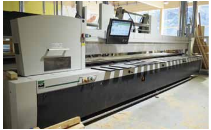
Puno drvo se najpre na Flexirip-u od Weinig Raimann-a razrezuje na potrebne širine...
