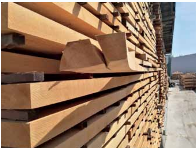
Slika 2. Deformacije već na prirodnom sušenju bukove rezane građe: bočna zakrivljenost (gore) i bočna zakrivljenost i raspuklina od bioloških naprezanja (dole)
