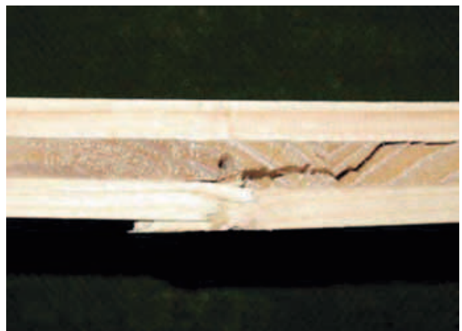
Slika 2: Lom troslojnog CLT-a prilikom savijanja
