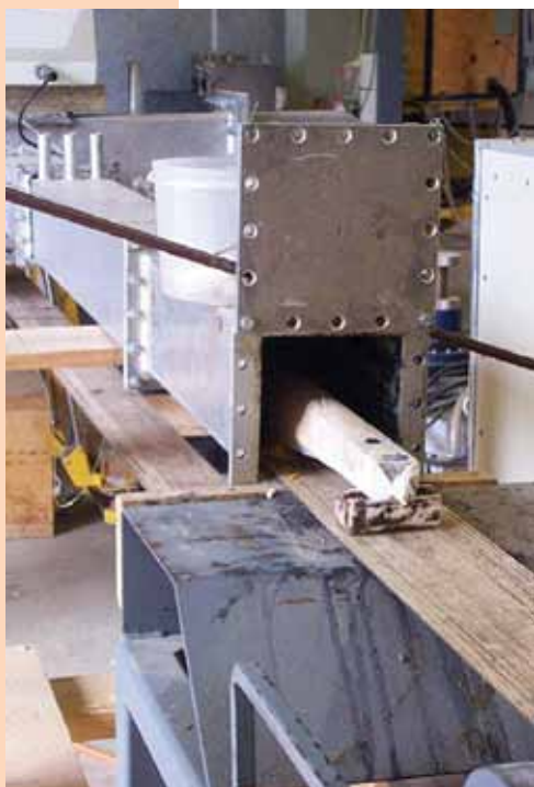
Slika 1: Komora za tretman drveta mikrotalasima velike snage
