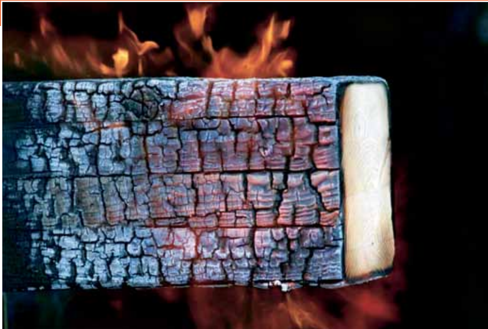
Slika 2. Ugljenisani sloj formiran sa sve četiri bočne strane drveta i nepromenjena unutrašnjost drveta
