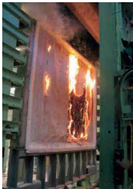
Slika 4. Testiranje požarne otpornosti drvenih panela
