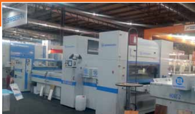
Slika 8. Linija za dobijanje dezena visokog sjaja na površini folija primenom digitalne štampe i inertne jedinice sa zaštitnom folijom za očvršćavanje (proizvođač: Barberán, Digital printing & inert finishing)
