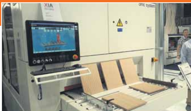
Slika 4. Različiti reljefi na medijapan pločama dobijeni kombinacijom glodanja i brušenja u jednom prolasku kroz mašinu (proizvođač Heeseman, model dmc system)
