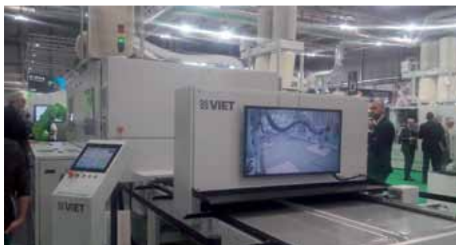
Slika 3. Mašina za brušenje sa dva integrisana robota (proizvođač: Biesse, model Viet Opera R2)
