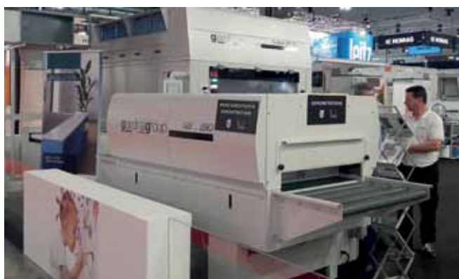
Slika 6. Uređaj sa eksimer lampom za površinsko očvršćavanja filma premaza (proizvođač GiardinaGroup, model GST ZERO)
