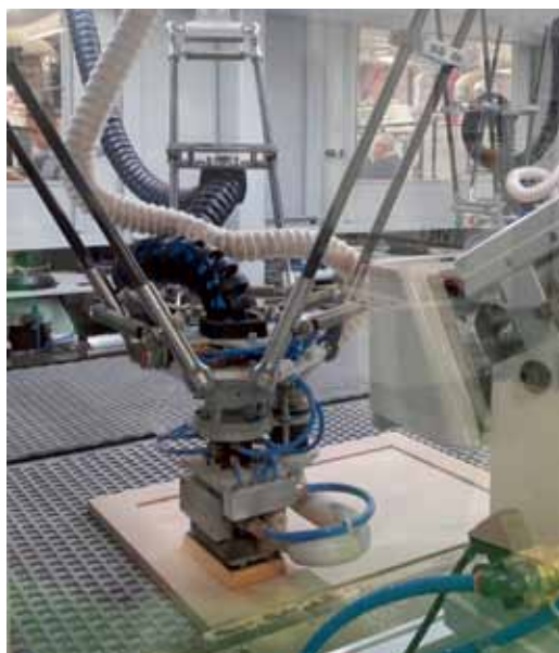
Slika 2. Robot za brušenje pločastih elemenata tokom rada (proizvođač: Biesse, model Viet Opera R2)
