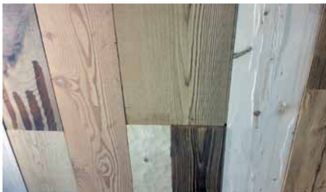
Slika 5. Izgled nekih od mogućih efekata površine dobijenih reljefnom obradom sa ili bez materijala za površinsku obradu
