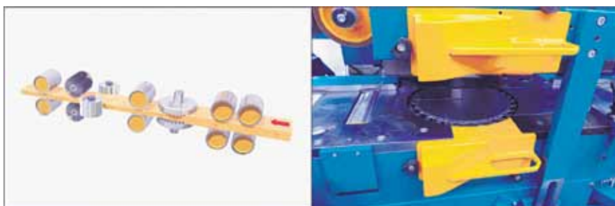
Slika 5: Mašina za pripremu masivnog drveta za lepljenje sa krunskim alatom („Rotoles“ princip)
