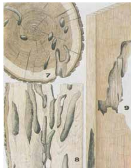
Cerambyx cerdo L. - velika hrastova strižibuba 7,8 i 9 - poprečni i uzdužni preseki oštećenja od larvi
