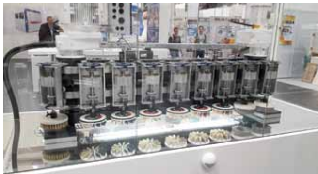
Slika 1. Model različitih tipova četkastih valjaka (proizvođač Heesemann, Nemačka)
