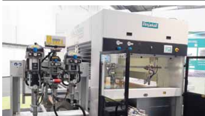
Slika 3. Automat za prskanje sa linearnim kretanjem raspršivača i sistemom za doziranje materijala (proizvođač: Venjakob, Nemačka)
