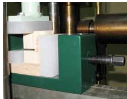
Slika 7: Alat sa postavljenim uzorkom ploče od masivnog drveta na automatskoj mašini za ispitivanje prema EN standardu (foto: Zdravković)
