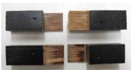
Slika 6: Izgled loma furnirske ploče po sloju drveta (gore) pri manjoj sili loma nego pri kombinovanom lomu (dole) (foto: Zdravković)
