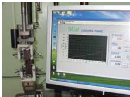
Slika 5: Snimak loma na automatskoj mašini za testiranje furnirske ploče prema EN standard
