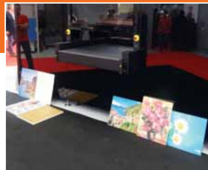
Slika 7. Ink-jet štampa dezena na širim stranama pločastih elemenata
