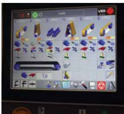
Slika 2. Ekran upravljačke jedinica mašine za brušenje širih strana ploča sa različitim agregatima za brušenje
