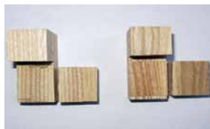
Slika 8: Izgled loma uzorka ploče od masivnog drveta po drvetu (levo) i loma po sloju lepka (desno) – nijedan uzorak ne zadovoljava uslove EN testa
