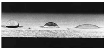
Slika 4: Testiranje površine drveta: water drop test
