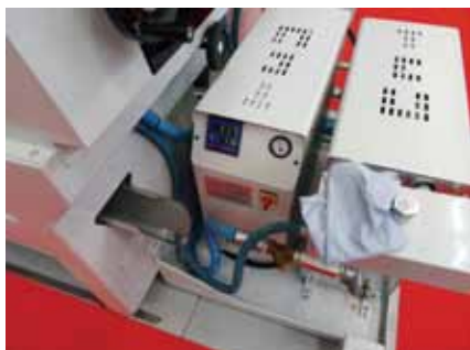
Slika 5. Jedinica za grejanje UV topljivog adheziva u sklopu „fusion coating” sistema
