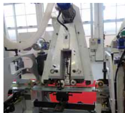
Slika 4. Agregat sa uskom trakom i pritiskom papučom za brušenje profila u protoku
