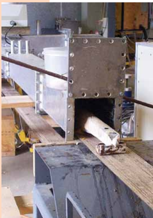
Slika 1: Komora za tretman drveta mikrotalasima velike snage
