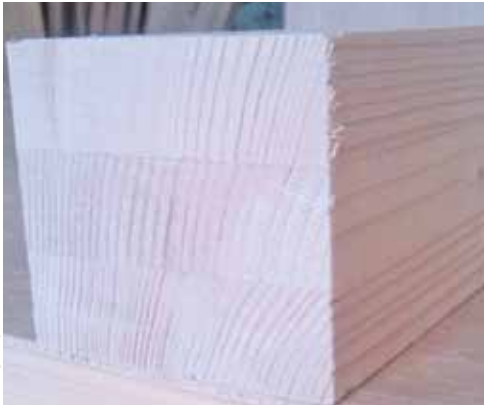
Slika 1. Lamelirano drvo smrče 72x86 mm
