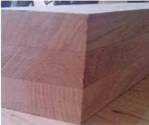
Slika 2. Lamelirano drvo hrasta 72x86 mm
