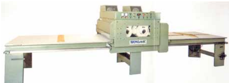
Slika 6. Mašina za poliranje sa pokretnim polirnim valjcima i nepokretnim radnim stolom (Technomac, Italy)
