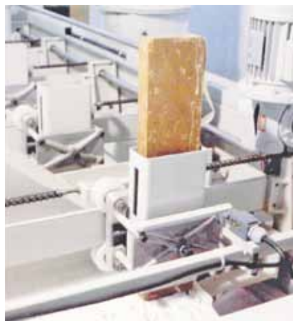
Slika 4. Nosač kalupa sa polirnim sredstvom na mašini za poliranje (DMC, Italy)
