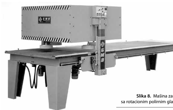
Slika 7. Mašina za poliranje sa nepokretnim polirnim valjcima i pokretnim radnim stolom (GMB, Italy)
