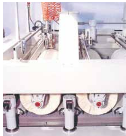
Slika 5. Par valjaka za poliranje (DMC, Italy)
