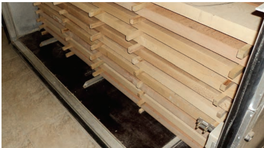
Slika 1. Naizmenično složeni redovi neparene i blago parene rezane građe bukve
