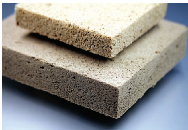
Izolacijske ploče od čvrste pene su 100% bazirane na drvetu.
