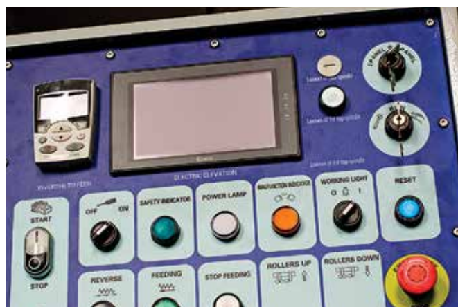
Brzina pomaka obratka kontroliše se inverterom i moguće ju je brzo i jednostavno menjati od 6 do 30 m/min s obzirom na potrebe obrade
