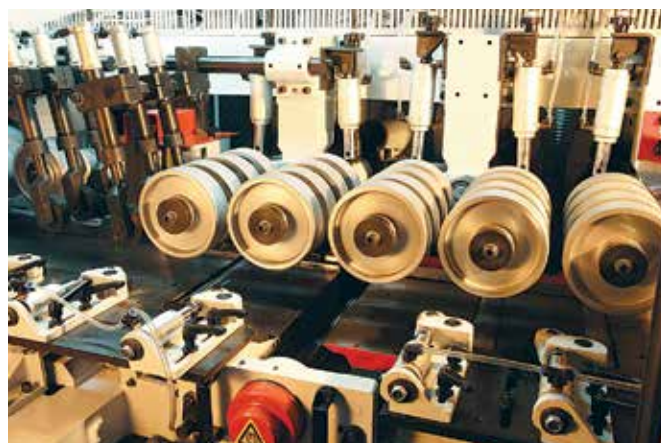
Rotacija transportnih valjaka ostvarena je snažnim kardanskim prenosom, što omogućuje siguran pomak, bez proklizavanja ili zaustavljanja obratka većih preseka (npr. krovnih konstrukcija)
