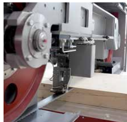
Detalj horizontalnog rezanja lamela
