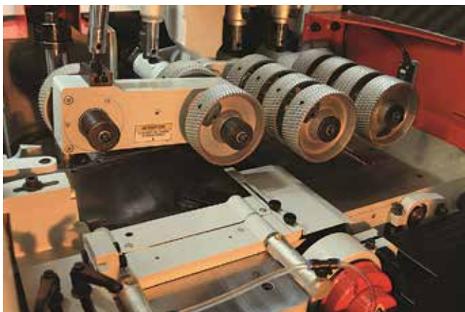
Sistem za obradu kratkih elemenata bitna je komponenta. Uz pomoć reznih vodilica na radnom stolu moguće je obraditi elemente dužine 250 mm
