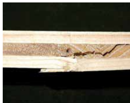
Slika 2. Lom troslojnog CLTa prilikom savijanja
