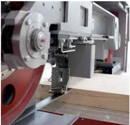
Detalj horizontalnog rezanja lamela
