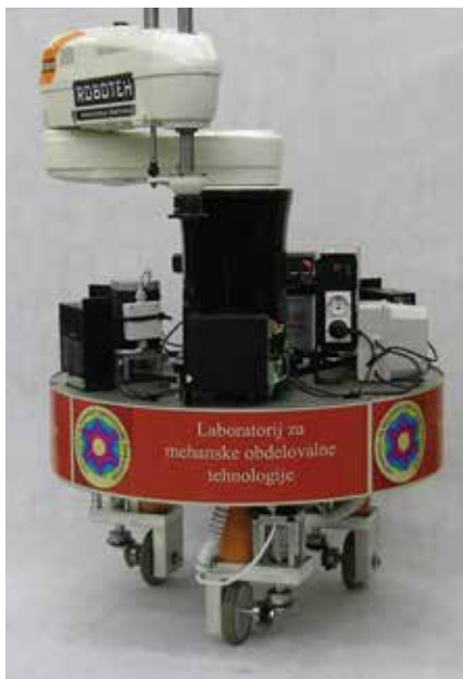
Slika 4. Prototip industrijskog robota na vođenoj mobilnoj platformi za proizvodnju komponenata za drvene zgrade proizveden na Univerzitetu u Ljubljani, Biotehnički fakultet, Odsek za drvenu tehnologiju
