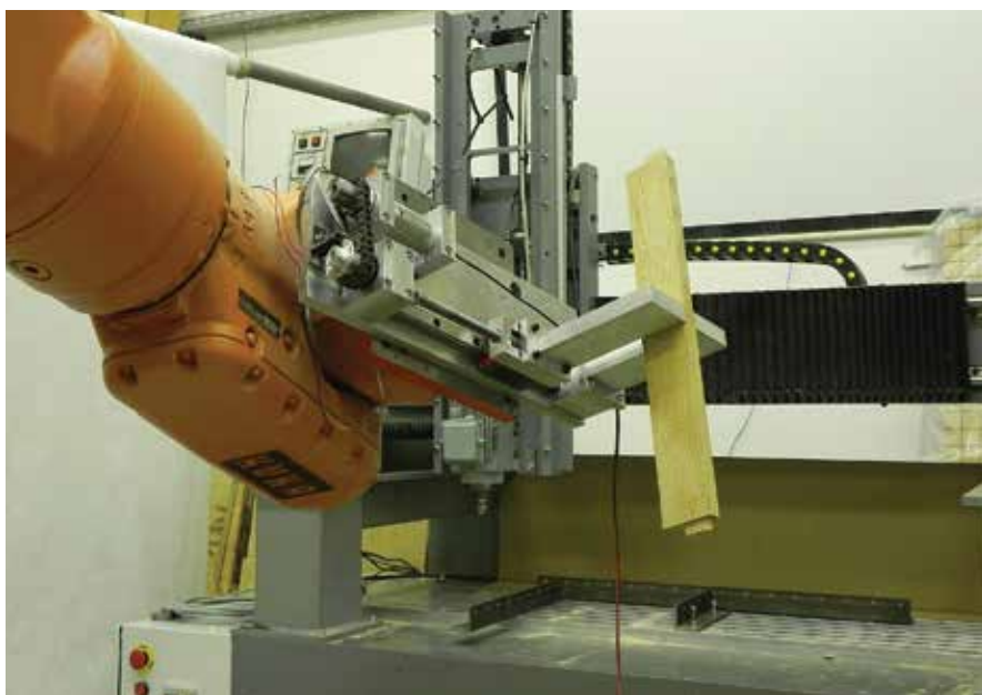
Slika 3. Prototip elektromotornog držača za posluživanje CNC mašina proizveden na Univerzitetu u Ljubljani, Biotehnički fakultet, Odsek za drvenu tehnologiju
