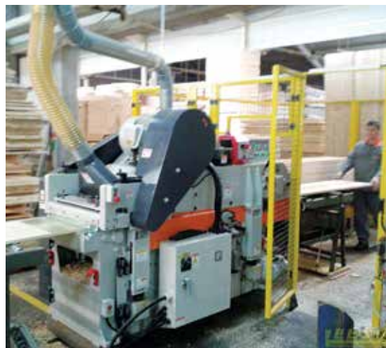
Rendisanje oplatnih ploča na tačno određenu dimenziju u preduzeću Javor Opažne ploče (Oplatne ploče) iz Pivke.
