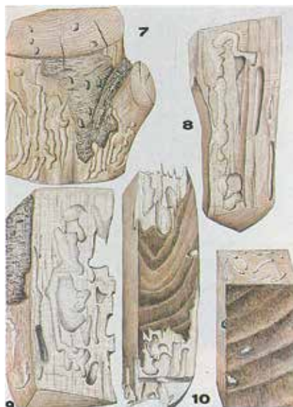
Stromatium fulvum V. - riđa kućna strižibuba 7 - 9 - tipovi oštećenja drveta od larava, 10 - izletni otvori imaga
