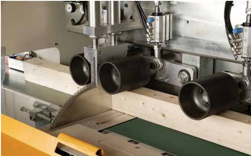
Označavanje kredom pre automatskog rezanja
