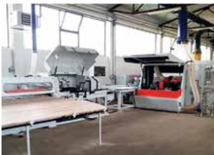
Postavljanje i puštanje u rad „fingerjoint“ linije u preduzeću Pilana Stojnić, BiH
