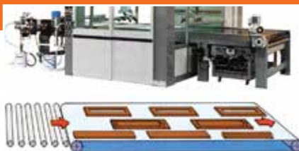
Slika 15. Transportni sistem sa beskonačnom transportnom trakom od sintetičkog materijala (Barberan)
