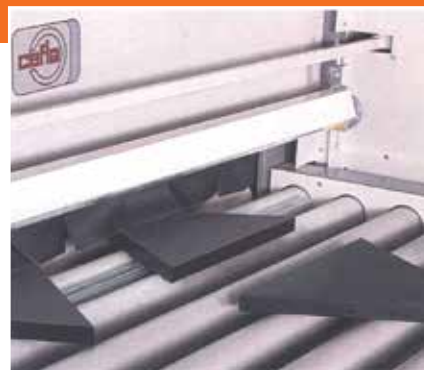
Slika 17. Nosač sa fotočelijama od 120 dioda za prepoznavanje oblika i dimenzija predmeta obrade (Cefla)
