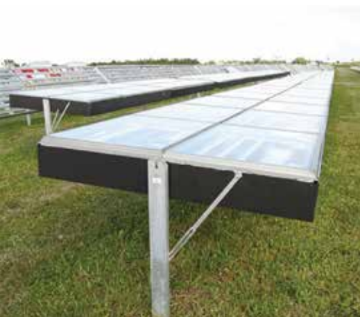
Slika 2. Ubrzani postupak ispitivanja vederinga u crnoj kutiji (www.q-lab.com)
