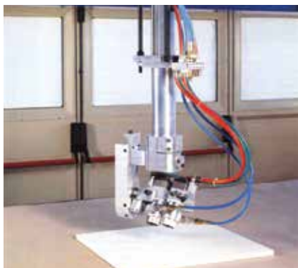
Slika 8. Raspršivači kod robota za lakiranje (Cefla)
