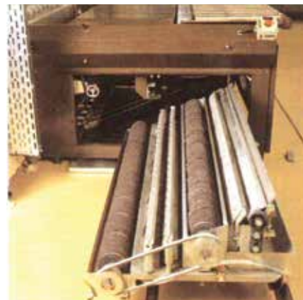
Slika 12. Uređaj za čišćenje čelične trake (Barberan) (Venjakob)
