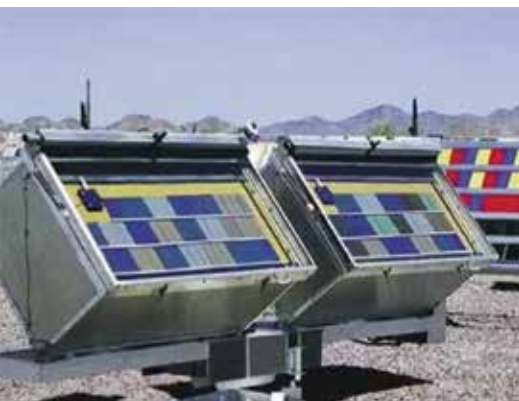
Slika 3. Ubrzani postupak ispitivanja vederinga u zagrevanoj crnoj kutiji
