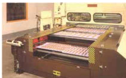
Slika 16. Transportni sistem sa paletnim transporterom (Venjakob)
