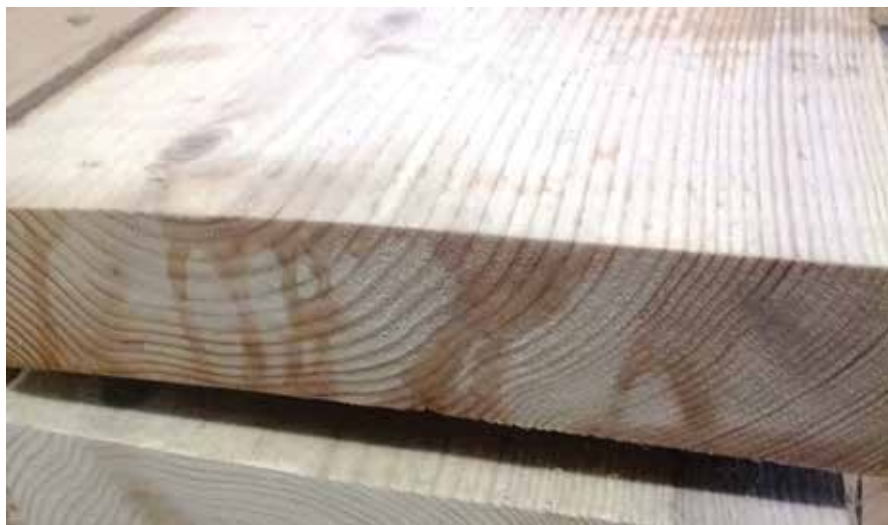
Slika 1. Izgled poprečnog preseka zaleđene građe jele
