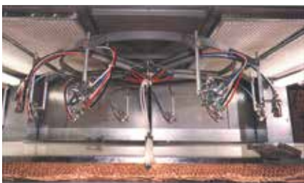
Slika 6. Automat za prskanje sa kružnim kretanjem raspršivača: gore - šematski prikaz, gore - izgled (Cefla)
