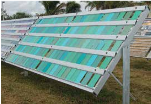
Slika 1. Neubrzani postupak ispitivanja vederinga na otvorenom prostoru
