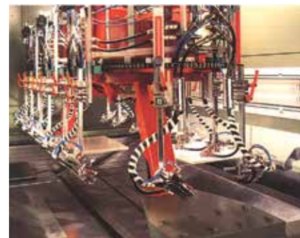
Slika 4. Automat za prskanje sa ovalnim kretanjem raspršivača (Venjakob)
