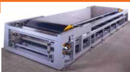
Slika 14. Izgled transportnog sistema sa čeličnom beskonačnom trakom (Giardina)
