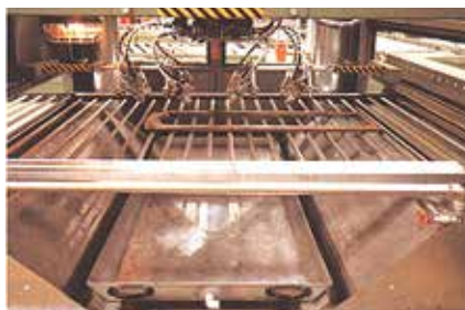
Slika 10. Letvičasti transporter kod automata za lakiranje prskanjem (Venjakob)
