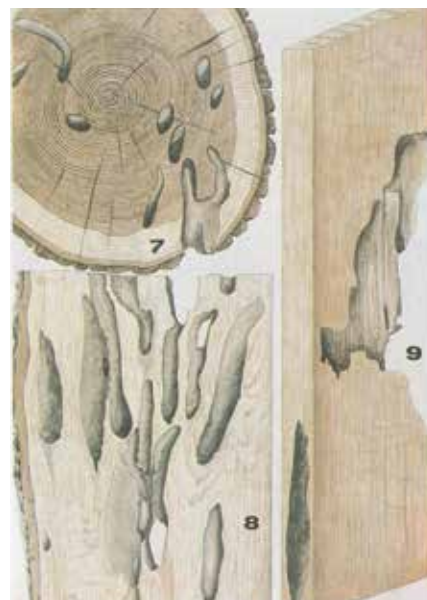
Cerambyx cerdo L. - velika hrastova strižibuba 7,8 i 9 - poprečni i uzdužni preseki oštećenja od larava
