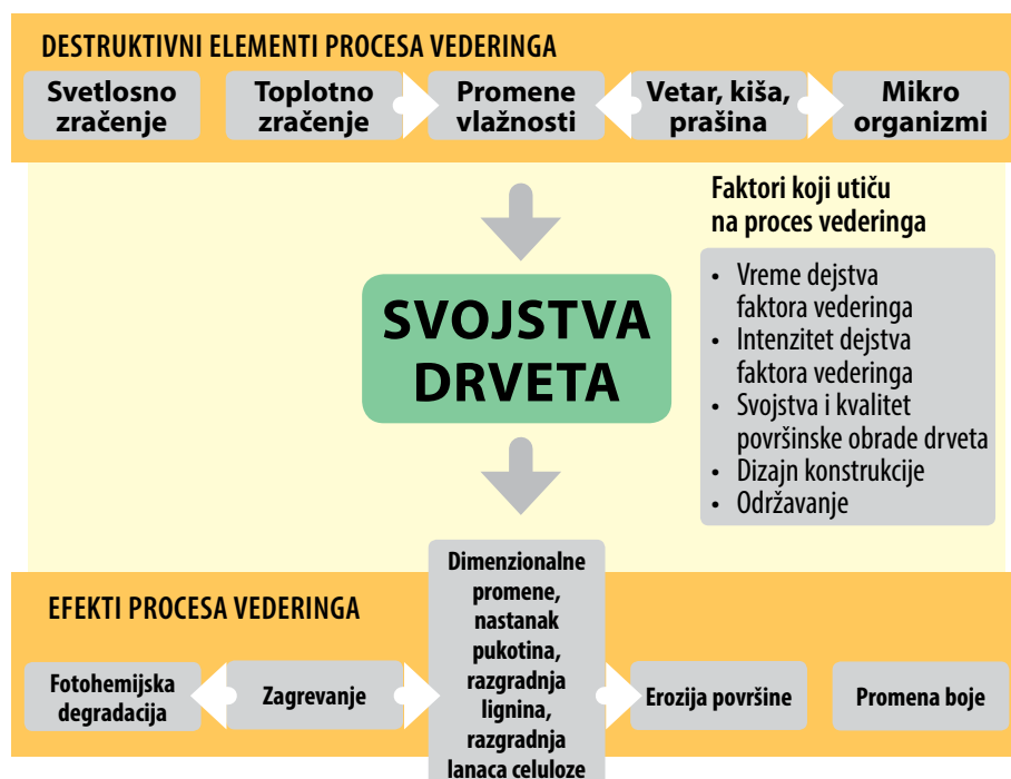
Slika 1. Shematski prikaz dejstva vederinga na svojstva drveta
