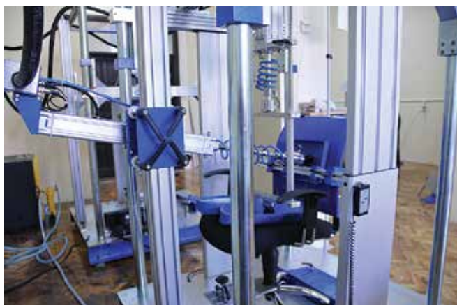
Slika 3. Uređaj za kontrolisanje sedišta i naslona
