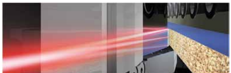
Slika 2: Prikaz ivične obrade uz pomoć lasera, (IZVOR: homag.com)
