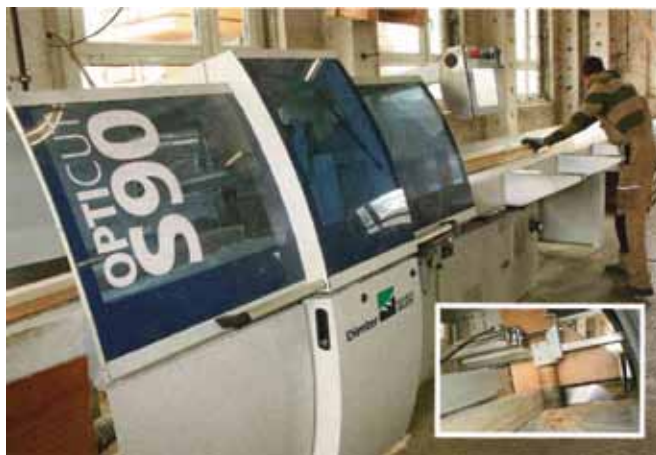
Dimter Opticut S 90XL kod Tews-a radi sa paketima do 150 kg; ispred i iza testere pritisni uređaj se stara za visoku preciznost (mala slika)
