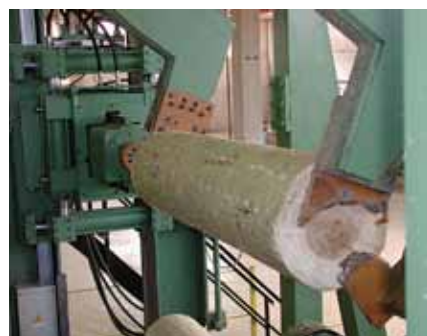
Slika 3. Uređaj za uvođenje centriranog trupca među hvataljke ljuštilice
