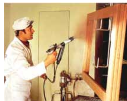
Slika 2. Uređaj za ručno elektrostatičko prskanje potpomognuto airless pumpom
