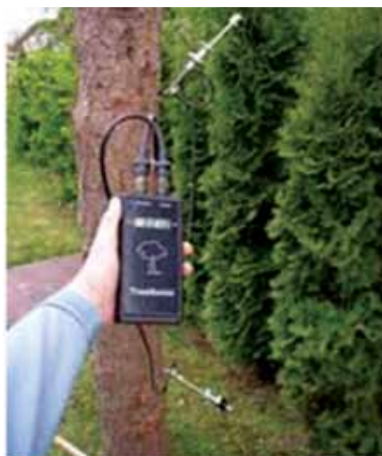
Slika 4. Određivanje brzine zvuka radi utvrđivanja elastičnosti drveta u stablu
