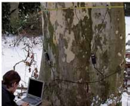
Slika 3. Primena akustične tomografije u cilju determinisanja zdravosti stabla (levo) i određivanje brzine zvuka na stablu (desno)
