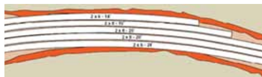
Slika 3: Krivolinijsko rezanje trupca dužine 4,8m – 14% veće iskorišćenje
