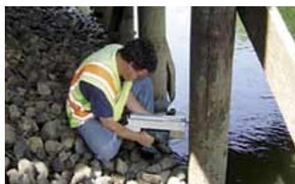
Slika 1. Primena metode ubušivanja i određivanje otpora prodiranju metalnog svrdla u drvo
