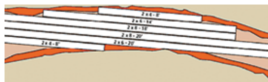
Slika 2: Konvencionalno rezanje trupca dužine 4,8m – samo dve daske pune dužine
