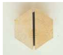
Slika 3: Izrezivanje lamela sa prorezanim srcem
