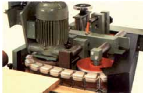
Slika 5. Agregat sa profilisanom brusnom trakom (gurnom)
