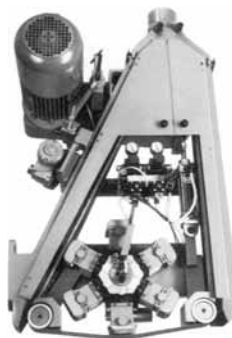
Slika 2. Agregati za brušenje profila sa beskonačnom brusnom trakom
