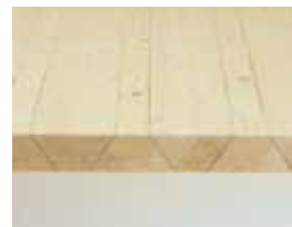
Slika 4: Izgled slepljene ploče od trouglastih lamela
