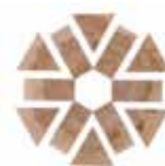
Slika 2: Plan rezanja trupca po zvezdastoj šemi
