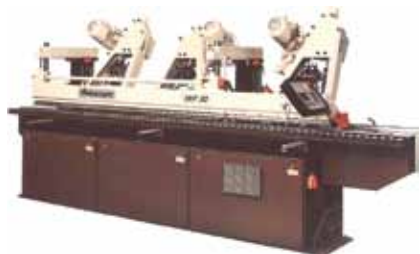
Slika 3. Brusilica za profilno brušenje sa više agregata (Heesemann)
