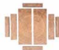
Slika 1: Konvencionalni plan rezanja trupca
