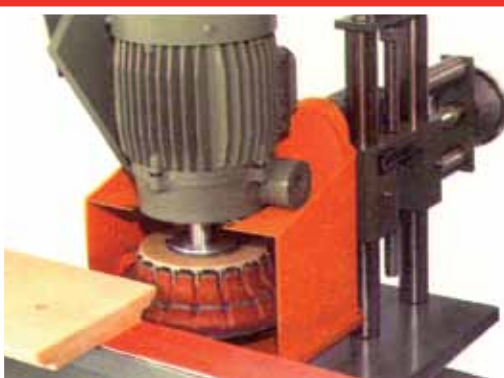
Slika 6. Agregat sa rotirajućim brusnim koturom
