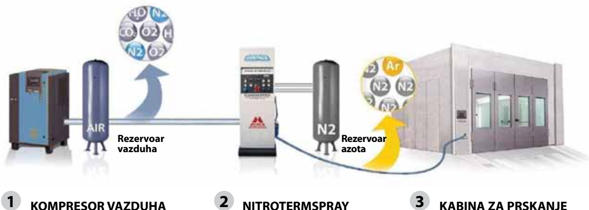
Slika 1. Shema kabine za prskanje sa NITROTERMSPRAY jedinicom
