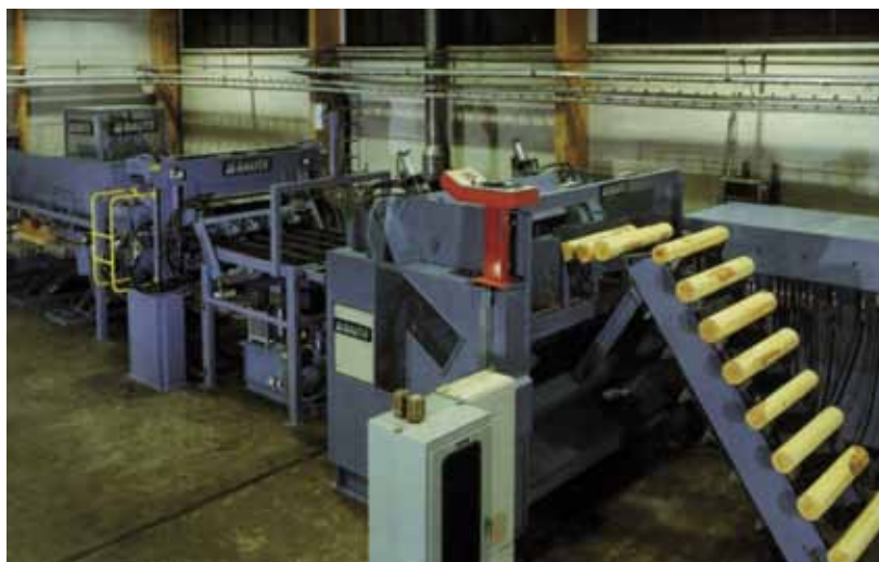
Slika 3. Dozirajući transporter za punjenje ljuštice zaokruženim trupcima
