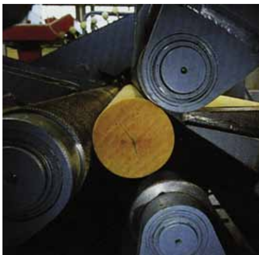
Slika 2. Položaj noža u odnosu na rotirajuće valjke
