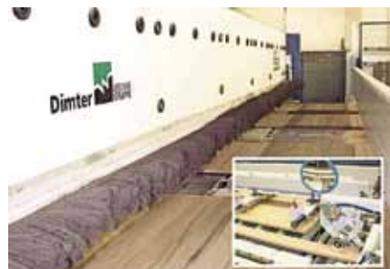
Do četiri ploče je moguće zalepiti na Dimter ProfiPress-i PPT 5500 VF
