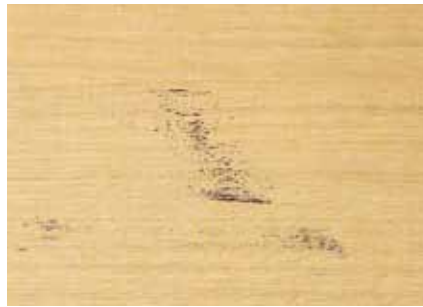
Slika 1. Mrlje na površini drveta
