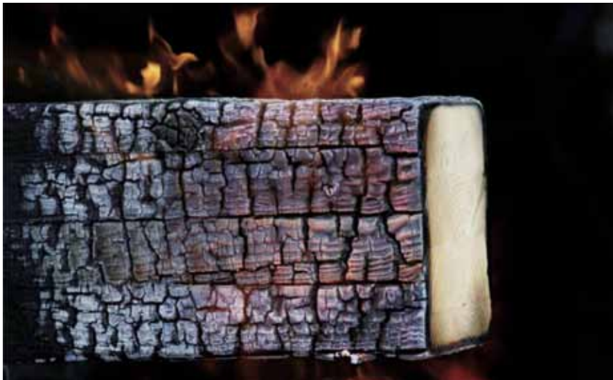
Slika 2. Ugljenisani sloj formiran sa sve četiri bočne strane drveta i nepromenjena unutrašnjost drveta
