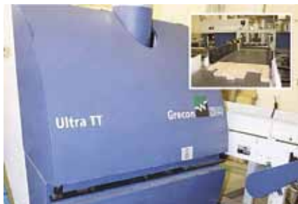
Linija za dužinsko spajanje Ultra TT od Grecon-a
