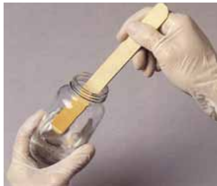
Slika 3. Pravljenje zasićenog rastvora oksalne kiseline
