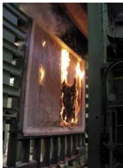
Slika 4. Testiranje požarne otpornosti drvenih panela
