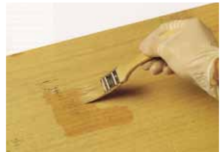
Slika 4. Nanošenje rastvora oksalne kiseline
