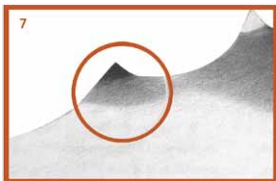
Slika 5: Testera se brzo istupi
