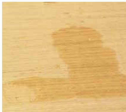
Slika 5. Delovanje sredstva za izbeljivanje
