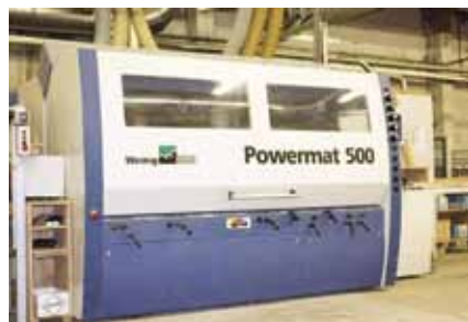
Dva Weinig Powermat-a 500 za savršenu obradu lamela
