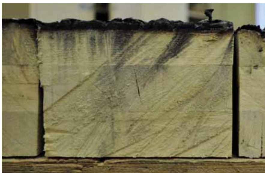
Slika 1. Ugljenisani sloj formiran na CLT (Cross Laminated Timber) nosaču
