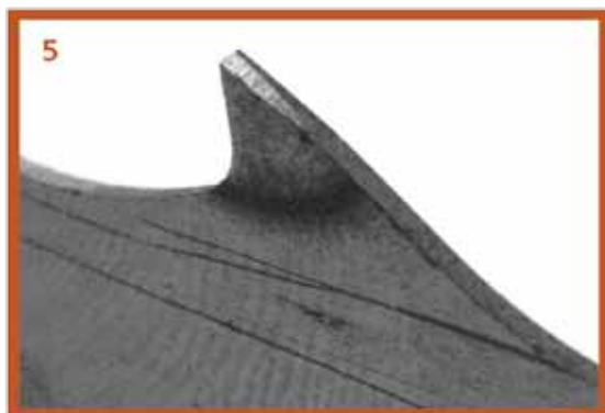
Slika 2: Testera se brzo tupi
