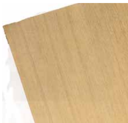
Slika 7. Rezultat uklanjanja mrlja oksalnom kiselinom - površina drveta bez mrlja
