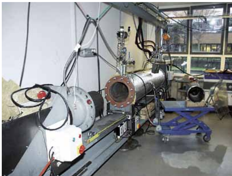
Slika 2. THM reaktor sa dvostrukim zidovima (zatvoreni sistem)
