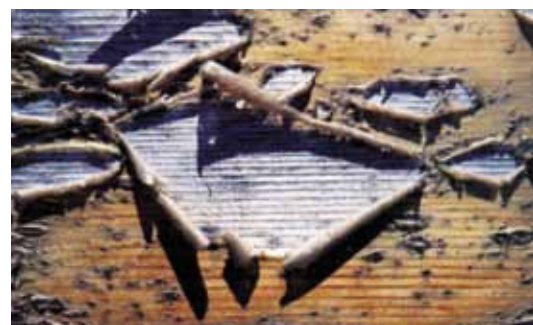
Lakovi pucaju i ljušte se za manje od dve godine ako nisu zaštićeni od delovanja sunca i kiše
