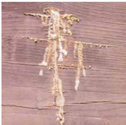
Smola koja je iscurila iz smolne vrećice na građi tretiranoj polutransparentnom lazurnom
