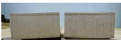
Slika 6. Smeđi sloj ispod površine na građi bukve
