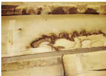
Slika 5. Diskoloracija na građi kestena kao posledica zadržavanja vode na površini
