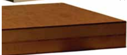
Troslojna panelploča sa srednjicom od šperploče i spoljnim listovima od medijapana veće debljine (12mm)
