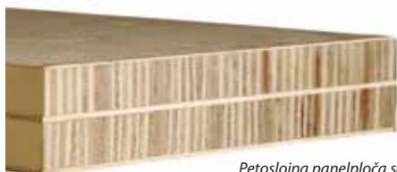
Petoslojna panelploča sa srednjicom od šperploče
