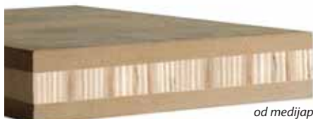
Troslojna panelploča sa srednjicom od šperploče i spoljnim listovima od medijapana
