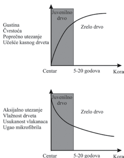
Slika 3. Uticaj juvenilnog drveta kod četinarica na fizička i mehanička svojstva
