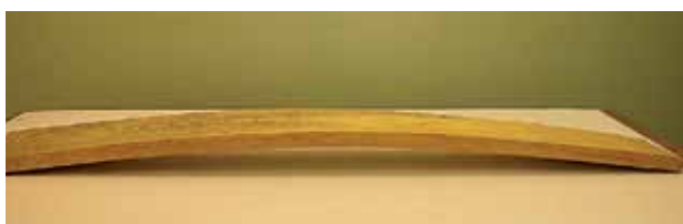
Slika 7. Uticaj kompresionog drveta jele na podužne deformacije
