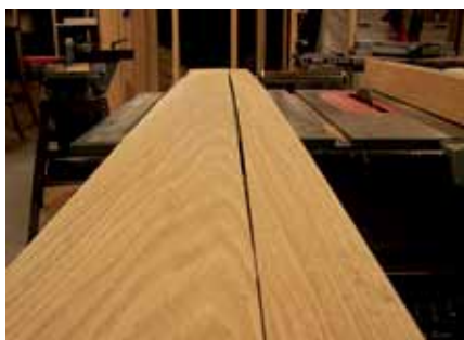
Slika 5. Tenziono drvo kod hrastovine prepoznatljivo po nepravilnim i širokim prstenovima prirasta
