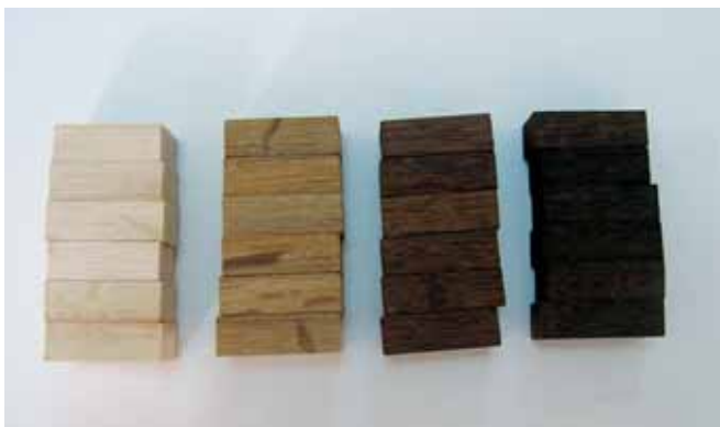
Slika 2. Levo su uzorci srčevine, a desno beljike hrasta kitnjaka. S leva na desno: netretirani uzorci, termički tretirani uzorci na 170°C, 190°C i 210°C u toku 4 h.
