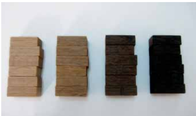
Slika 2. Levo su uzorci srčevine, a desno beljike hrasta kitnjaka. S leva na desno: netretirani uzorci, termički tretirani uzorci na 170°C, 190°C i 210°C u toku 4 h.
