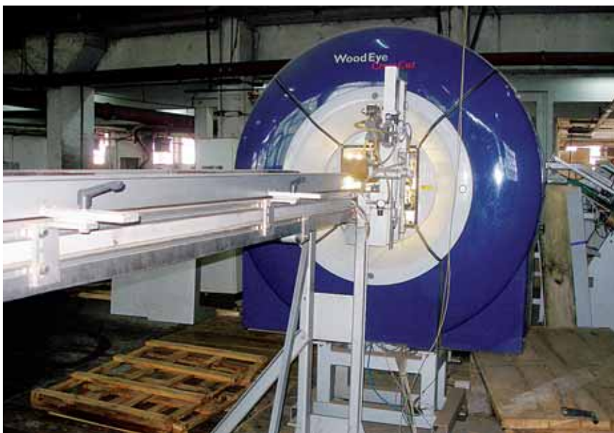
WOOD EYE, linija za čitanje grešaka u drvetu i upravljanje razvrstavanjem elemenata
