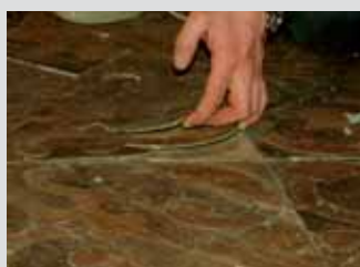
Postupak furniranja površine sa ručno sečenim segmentima od takozvanih drvenih pločica – BLIND FURNIR (debljina furnira oko 8mm)
