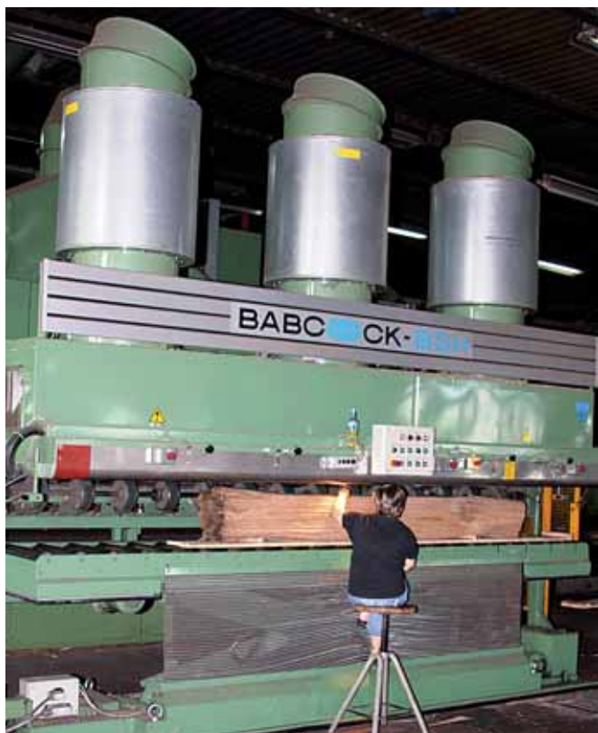
Tehnološki najnovija BABCOCK sušara za peglanje i sušenje furnira instalirana u Slavonija DI 2007. godine. Štedi energiju, povećava kvalitet i smanjuje greške.
