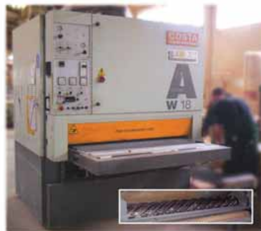
COSTA, brusilica/kalibrirka - sa spiralnom glodačkom glavom
