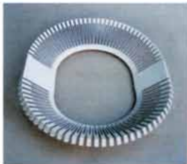
Šperploča rezana u jednom pravcu. Razmak između rezova i njihova širina određuju opseg deformacije
