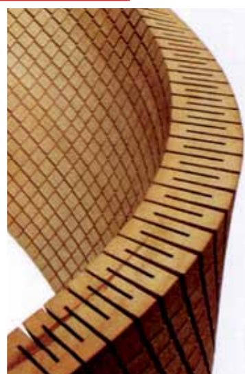
Masivna ploča drveta koja je rezana i u poprečnom i uzdužnom pravcu da bi postala elastična
