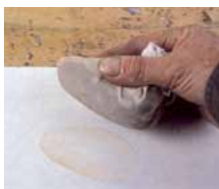
Sl. 8. Odgovarajuća količina politure: određeni otisak stopala sa politurom obezbeđuje nanošenje politure u kontrolisanom pravcu
