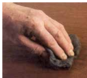
Sl.13 Matiranje čeličnom vunom ili najlonskom abrazivnom krpom podmazanom voskom. Nežno trljajte u pravcu vlakanca
