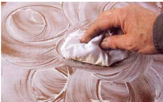
Utrljajte pastu za zapunjavanje u pore drveta kružnim pokretima i snažnim pritiskom
