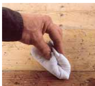
Oblikujte vrh jastučeta duž savijene strane. Oblikujte jastuče kruškolikog oblika sa zadržanim vrhom.
