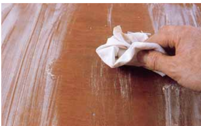
Skinite višak zapunjača kretanjem jastučeta poprečno na vlakanca
