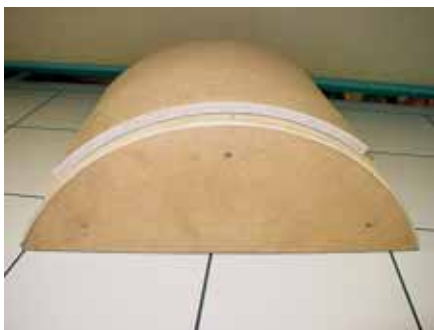
Šabloni sa termoformiranim elementima od SSV materijala
