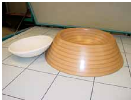
Šabloni sa termoformiranim elementima od SSV materijala
