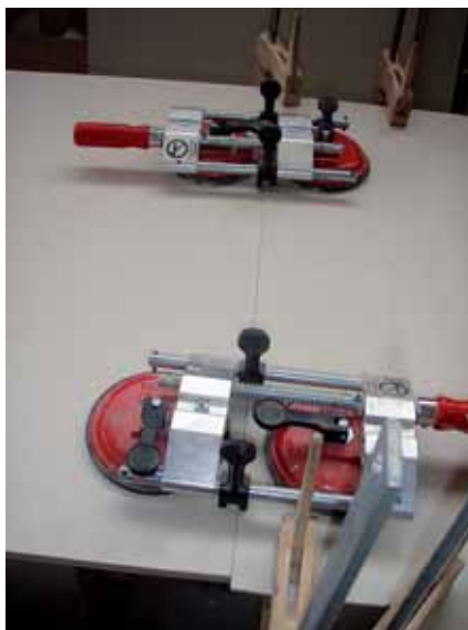
Spoj dve ploče sa sistemom vakuum stega
