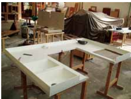
Izrada radne ploče sa integrisanom sudoperom i diht lajsnom od SSV materijala
