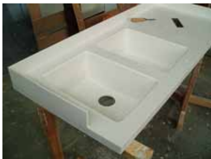
Izrada radne ploče sa integrisanom sudoperom i diht lajsnom od SSV materijala
