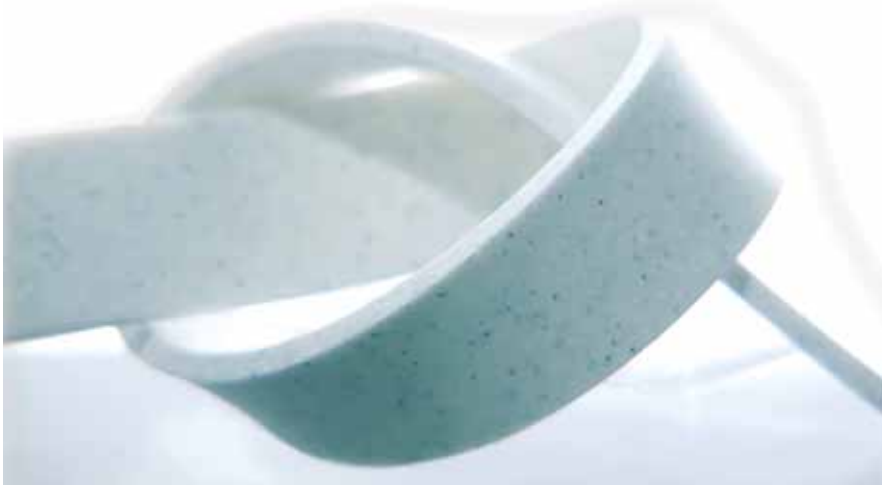
Mogućnost oblikovanja i savijanja SSV materijala u 3D oblike - termoformiranje
