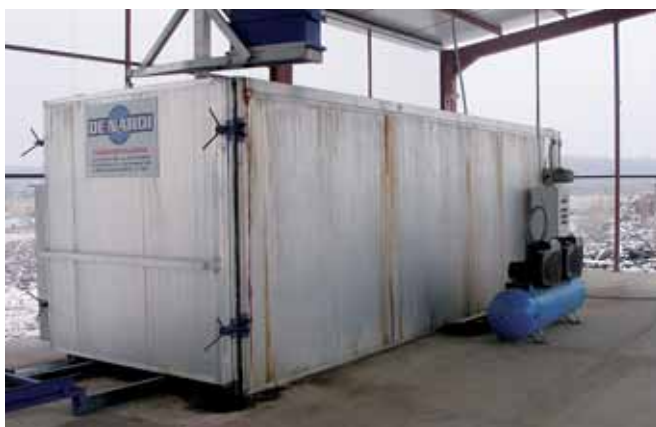
Komora za termotretiranje drveta
