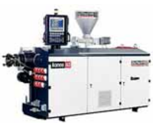
Slika 3. Dvopužni ekstruder za prerađu kompozitnih materijala drvo-polimer
