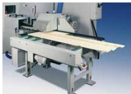
Šaržeri za kontinuirano punjenje ispred četverostranih blanjalica tipa: M11/13/15/20, ulazna i izlazna mehanizacija, tipa E1-E9 i A1-A10.
