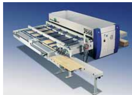
Tople prese za širinsko lepljenje lamela. Tip: ProfiPress L/T i C.
