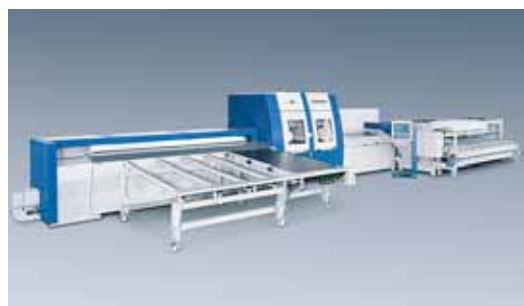
Conturex: Univerzalni CNC obradni centar za izradu elemenata nameštaja, za prozore...
