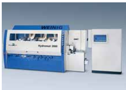
Hidromat serija: četverostrane blanjalice sa hidro-glavama, velikih brzina Tip: Hidromat 1000/2000/3000...
