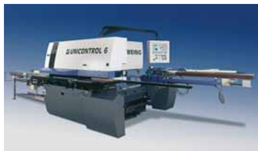
Obradni centri za stolariju, zavisno od kapaciteta i komfora rukovanja. Tip: Unicontrol 6/11, Linija Unitec 15, Unirex.
