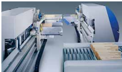
Linija za dužinsko nastavljivanje kratkog ili dugog drveta. Za izradu masivnih ploča, za krovne konstrukcije... Tip: ProfiJoint, PJ kombinacija, Ultra, Combipact, Turbo S, HS 120/180/180 Spinfeed.
