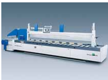
Flexirip: podužni raskrajač od 3,2-9,2 m, visina rezanja do 190 mm.
