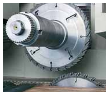
Dvoosovinski cirkular ProfiRip KDR 310, maksimalna visina reza 180 mm.
