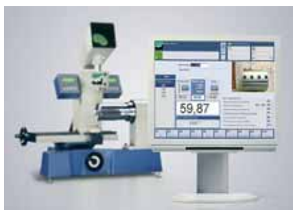
Opticontrol: elektronski uređaj za optičko merenje alata.
