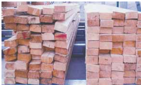
Slika 3. Neopterećeni i opterećeni složaj nakon sušenja
