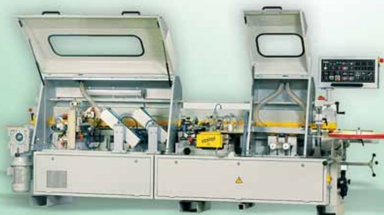
CEHISA Series 303P AGREGATI: ▪ PREFREZER SA DIJAMANTSKIM GLAVAMA ▪ SEČENJE NA MERU SA DVA MOTORA SA PNEUMATSKIM POZICIONIRANJEM SA KONTROLNE PLOČE ▪ GORNJA I DONJA OBRADA IVICA SA DVA MOTORA NA 12.000 OBRTAJA
