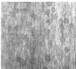
Slika 2. Izbočine u obliku prstena. Kada temeljni sloj može da rastvori prethodno nanet bajc, jer sadrži rastvorljive organske supstance za bojenje, rastvoreni deo upije lak, što rezultira efektom prikazanim na slici kod tvrdog i poroznog drveta.
